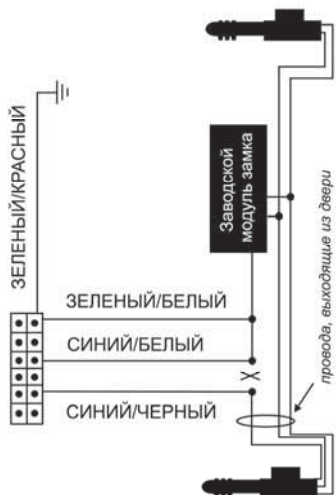
Схема 5. Однопроводный тип цепи дверных замков с отрицательной полярностью (некоторые автомобили марки Ниссан, Mazda и др.)
